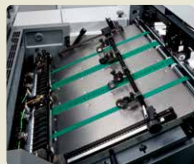
Quadro dell'alimentatore del nastro di aspirazione
