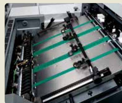
Quadro dell'alimentatore del nastro di aspirazione
